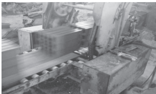
Figura 6- Máquina computadorizada de finalização da produção do bloco. Fonte: FIGUEIREDO, 2011, pesquisa de campo em 13/07/2011.
