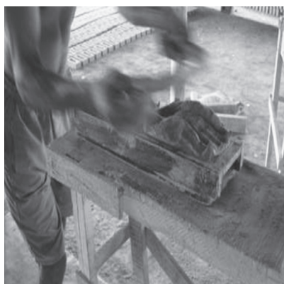
Figura 10- Etapa do processo produtivo dos tijolinhos, e retirada do excesso de barro.
