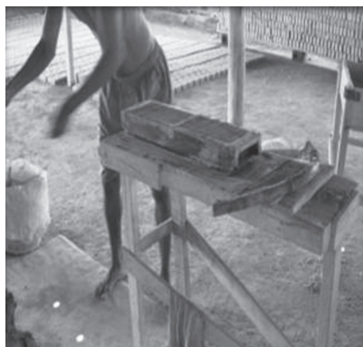
Figura 8- Etapa do processo produtivo dos tijolinhos, colocação na forma.
