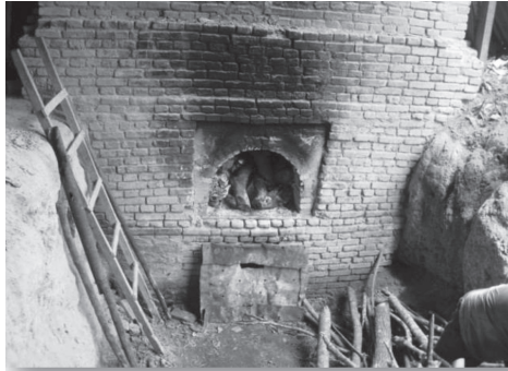
Figura 5- Forno de olaria utilizado para queima das telhas e tijolinhos. Fonte: FIGUEIREDO, 2011, pesquisa de campo em 24/05/2011.
