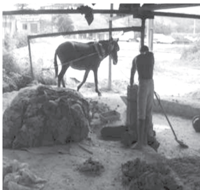
Figura 7 – Mistura do selao e argila com tração animal.
