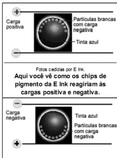
Figura-04: Tinta eletrônica
