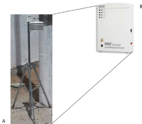
Figura 5. (A) Mini-abrigo apoiado no tripé (Fonte: a autora). (B) Termo-higrômetro (Fonte: One Temp®).
