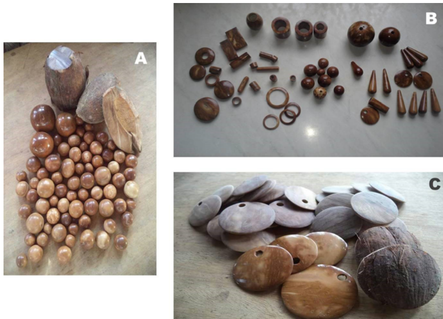
Figura 7. Produção de biojóias a partir do coco da piaçava no município de Ituberá. Transformações no coco da piaçava após lapidação, polimento e envernização, com aplicação da camada de cera para impermeabilização (A, B e C). Diferentes formatos das peças após o processo de polimento (B).
