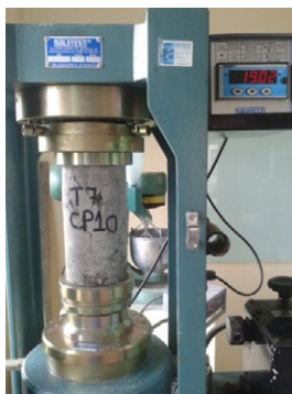
Figura 8 – Corpo de prova sendo rompido à compressão.
