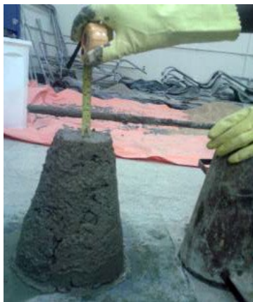
Figura 5 - Ensaio de abatimento do traço T4 após acréscimo de 4,5 kg de água.
