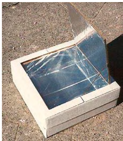
Figura 02. Revestimento da caixa com papel alumínio.
