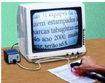
Ilustração de um monitor branco, cuja tela mostra letras ampliadas. Dele sai um cabo conectado a um pequeno dispositivo segurado por uma mão, o qual está sobre uma folha com letras muito pequenas.
