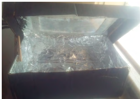
Figura 04. Forno de Papelão heliotérmico.
