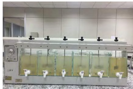
figura22 – decantação/sedimentação após 30 minutos
