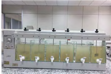
figura 18 – decantação/sedimentação após 10 minutos
