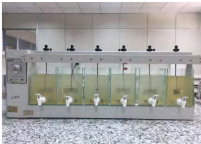
figura 21- decantação/sedimentação após 25 minutos
