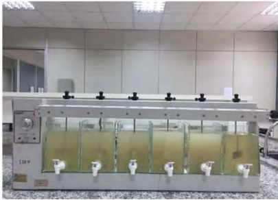
figura 19 – decantação/sedimentação após 15 minutos
