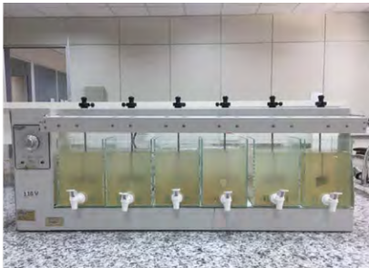
figura 21- decantação/sedimentação após 25 minutos
