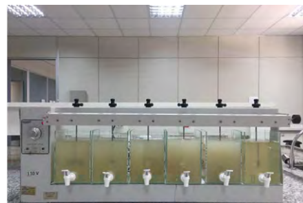
figura 16 - processo de decantação/ sedimentação
