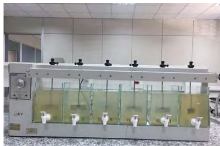
figura22 – decantação/sedimentação após 30 minutos
