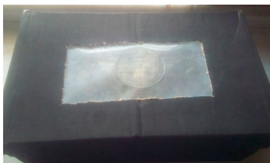
Figura 05. Forno de papelão com um copo de água em seu interior
