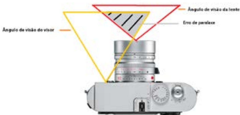
Figura 50 – Esquema representando erro de paralaxe na fotografia
