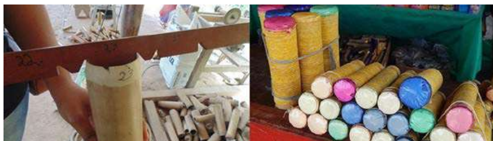
Figura 6: Régua utilizada para medir a espessura da taboca (a esquerda) e espadas prontas para uso e comercialização (a direita).
