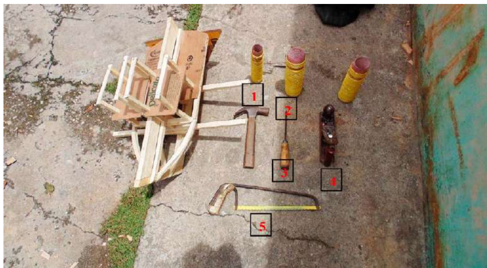
Figura 7: Estrutura do barco-de-fogo e ferramentas utilizadas para confecção
