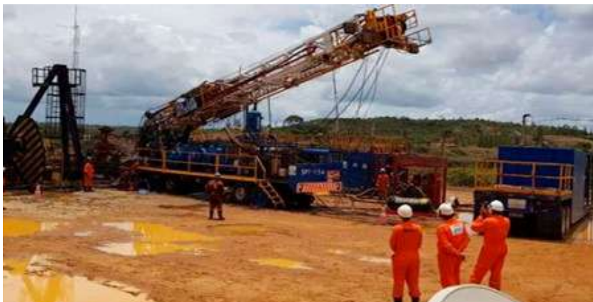
Figura 02 – Sonda de produção terrestre elevando o mastro
