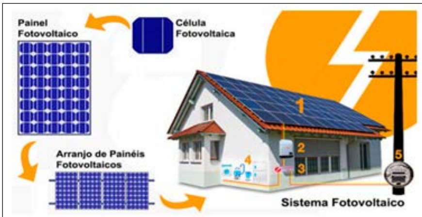
Figura 3 – Sistema fotovoltaico conectado à rede ou ON-Grid.
