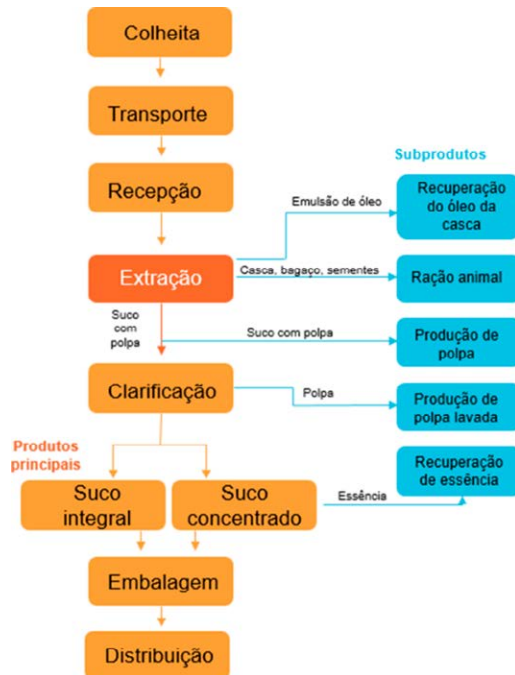
Figura 2 – Esquema de produção de suco de laranja
