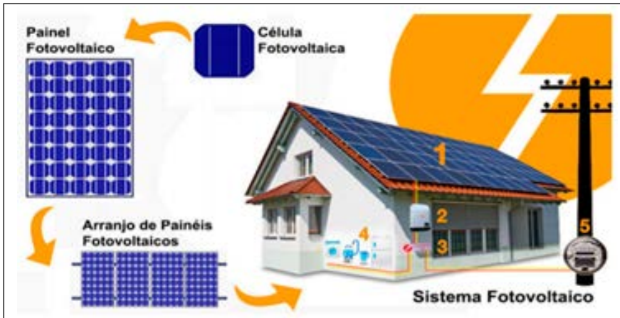
Figura 3 – Sistema fotovoltaico conectado à rede ou ON-Grid.
